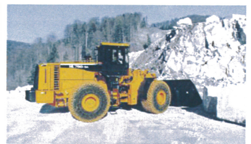
o.: Der neue Großradlader HL780-9A mit 30.300 kg Einsatzgewicht, 23,7 kN Grabkraft und einem 264 kW starken Cumminsmotor nach Tier IIIb/Tier 4 Interim.
